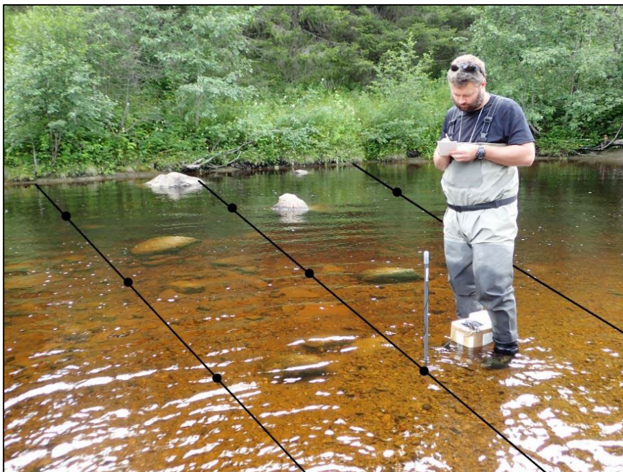
Foto 4.2. Redoksmåling. Fotografiet viser en redoksmålingsstasjon i Elstadelva i Grong kommune i Trøndelag. De svarte strekene og sirkelene indikerer henholdsvis transektene og målepunktene ved stasjonen. Ved det ene målepunktet tas det en redoksmåling i substratet. Foto: Bjørn Mejdell Larsen. Figuren er opprinnelig figur 2.1 i NINA Rapport 1623 (Magerøy & Larsen 2019).
