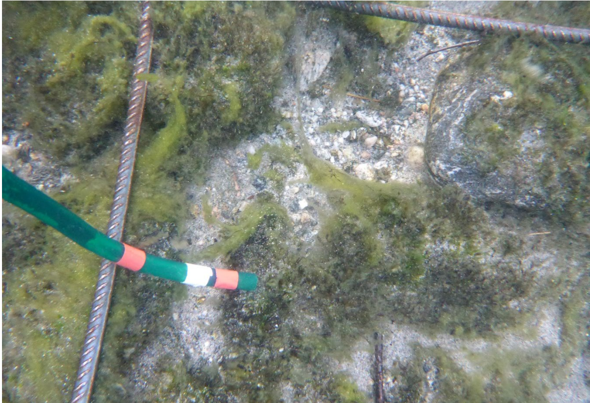
Bilde 2. Måling av hulrom i elvebunnen skjedde ved hjelp av fleksibel plastslange i henhold til metode beskrevet av Finstad et al. (2007). Foto: Jan Gunnar Jensås.
