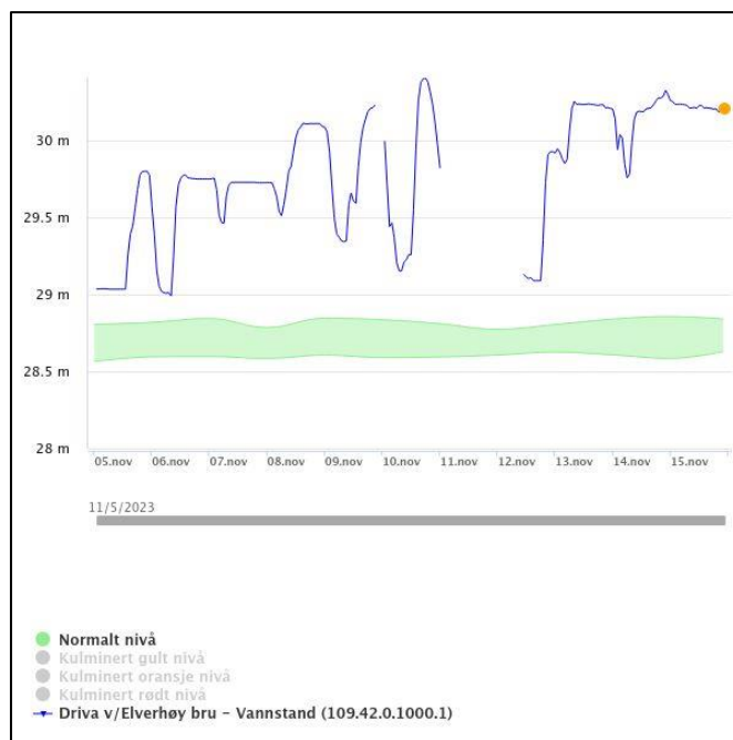
Figur 10. Eksempel på vannstand og vannstandsendringer ved Elverhøybrua i Driva i november 2023. Fra kl. 02.00 til kl. 04.00 den 9. november og kl 01.00 til 03.00 den 10. november ble vannstand senket ca. 40 cm ved målestasjonen 11 km nedstrøms kraftverksutløpet. Data fra hentet fra https://sildre.nve.no/sildre/ .
