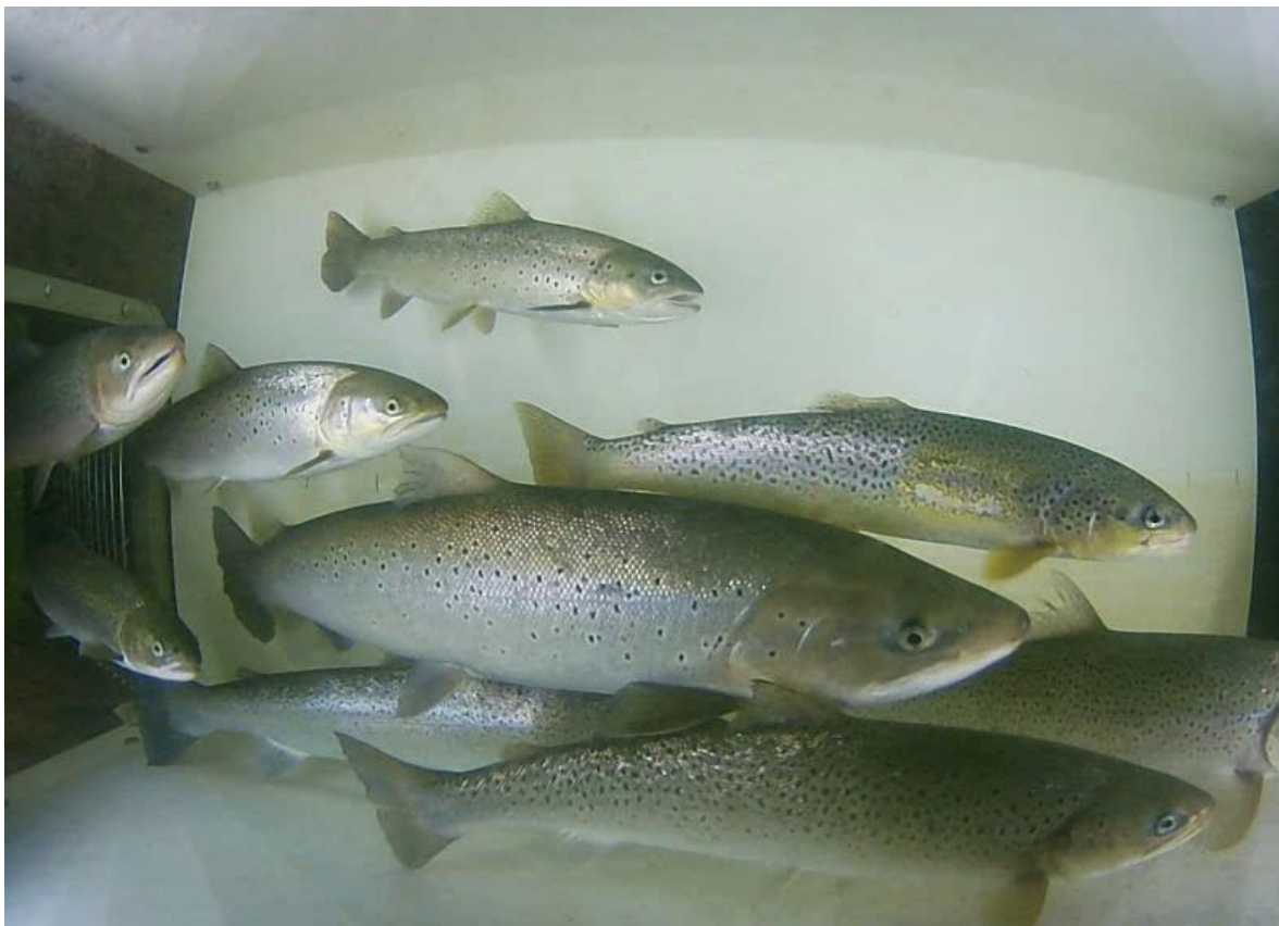
Bilde 7. Ni sjøørreter er inne i tellekammeret samtidig. I dette tilfellet passerte det over 20 fisk på et par minutter. I slike tilfeller klarer ikke telleren å registrere all fisk som passerer.
