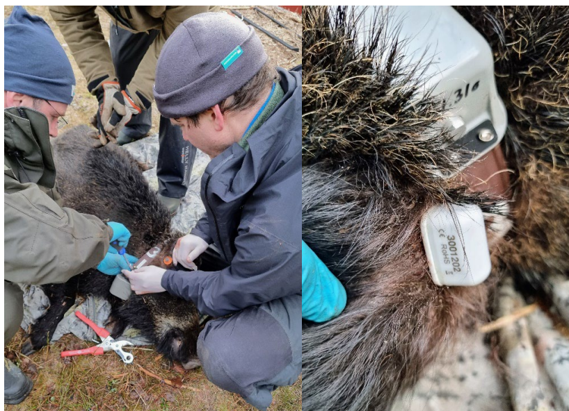
Figur 11. Bilde til venstre viser påsetting av GPS-halsbånd på villsvin og bilde til høyre viser øresenderen ferdig påmontert.
