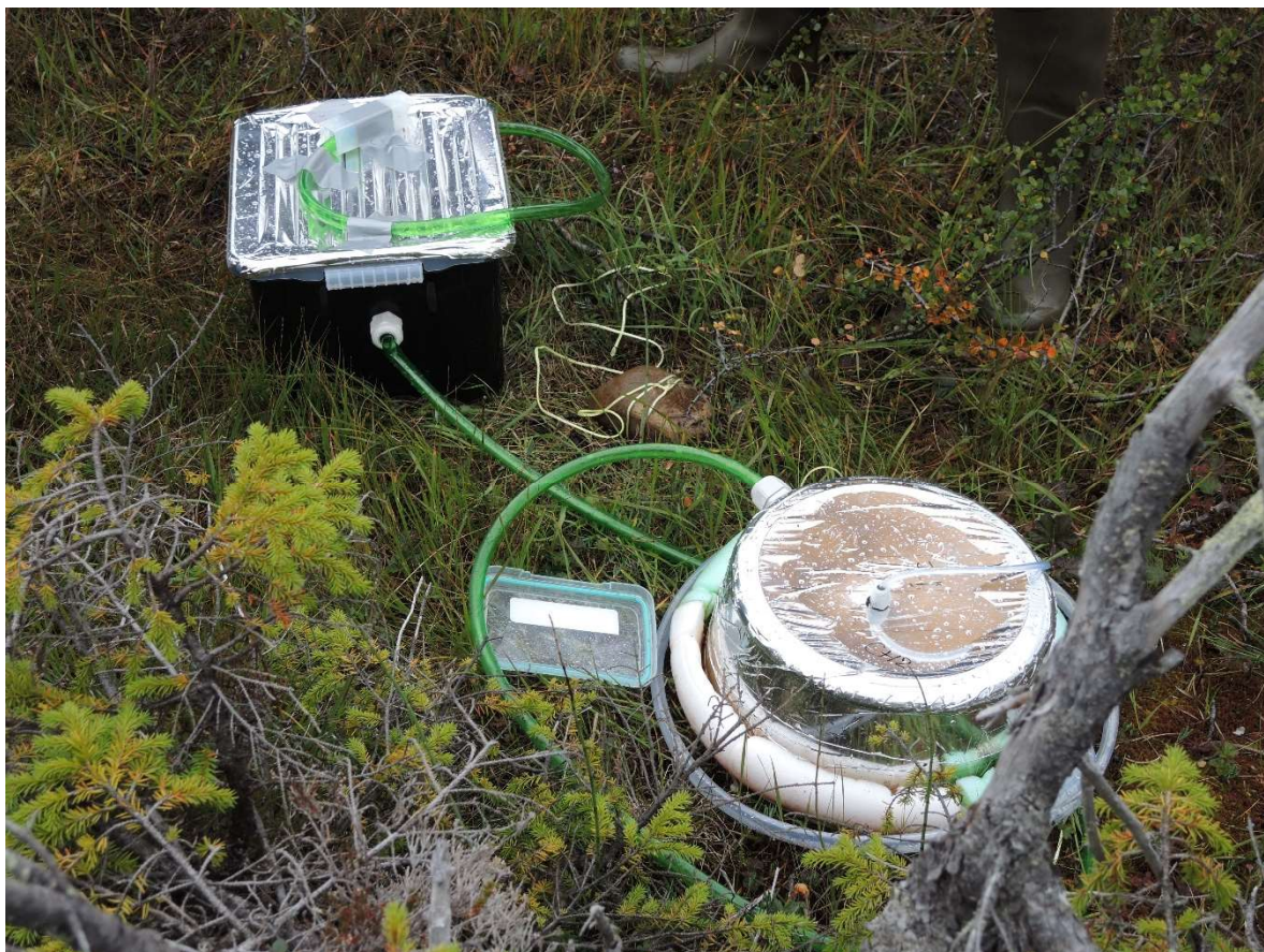
Figur 17. Prototyp på utstyr for måling av opptak og utslepp av klimagassar i ferskvatn. Foto: Anders Lyngstad 21.8. 2023.
