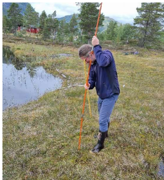
Figur 4. Måling av torvdjup med sonde. Foto: Trond Simensen 30.8. 2023.
