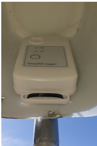
Figur 31. Temperatur og luftfuktighetsmåler av typen Hobo MX2301A. MX2301A er plassert i skygge og data kan hentes med blåtann til en skyløsning.
