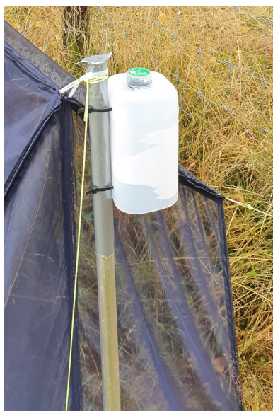
Figur 32. Temperatur og lysmåler av typen Hobo MX2202 (grønn knapp). MX2202 er plassert i sol og data kan hentes med blåtann til en skyløsning.
