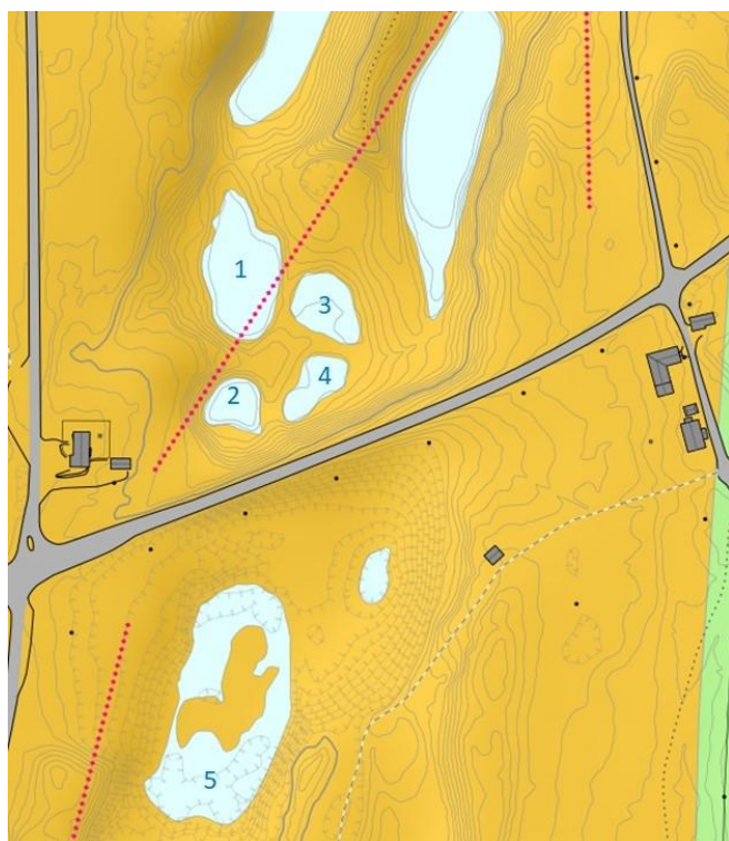
Figur 2.1. Løsmassekart over dammene sør for Vesle Ossiøen i Trysil kommune. Gul farge er sorterte breelvvavsetning, ofte skråstilte lag av forskjellig kornstørrelse fra fin sand til stein og blokk. Rød stiplet linje er ryggformet breelvvavsetning. Kilde: http://geo.ngu.no/kart/losmasse/
