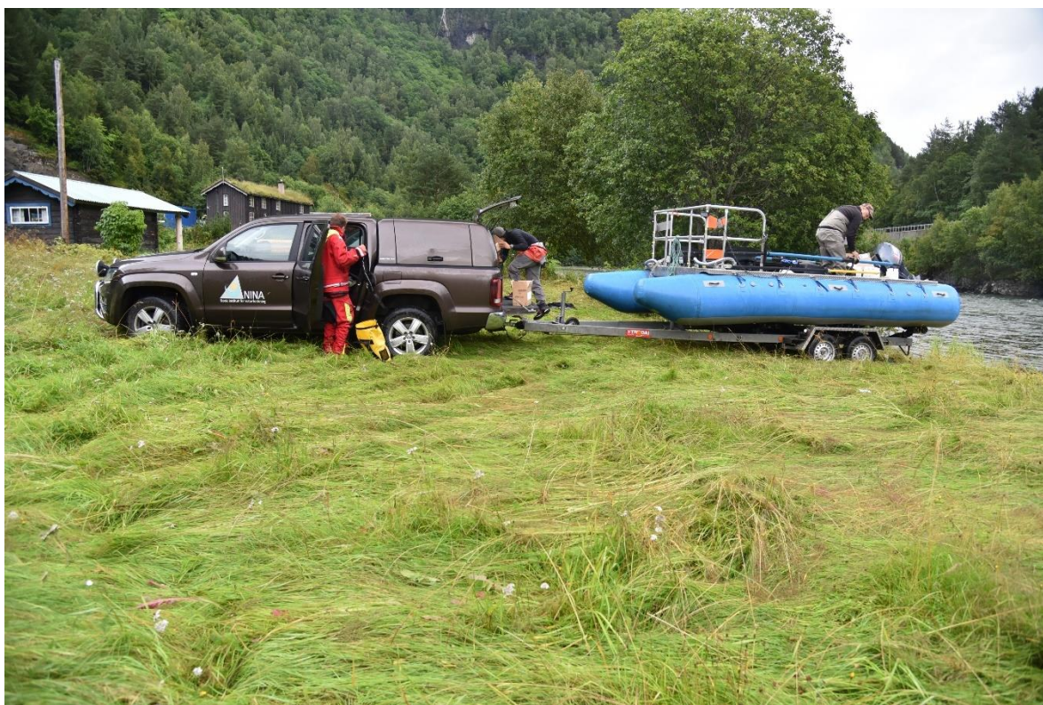
Bilde 4. Det ble benyttet en flatbunnet båt med luftfylte pontonger under det elektriske båtfisket i Driva. Denne båten er best egnet i grunne elver uten egnede utsetningsplasser for båt. Illustrasjonsbildet er fra utsetningsstedet nedstrøms Grensehølen. Foto: Anders Foldvik.
