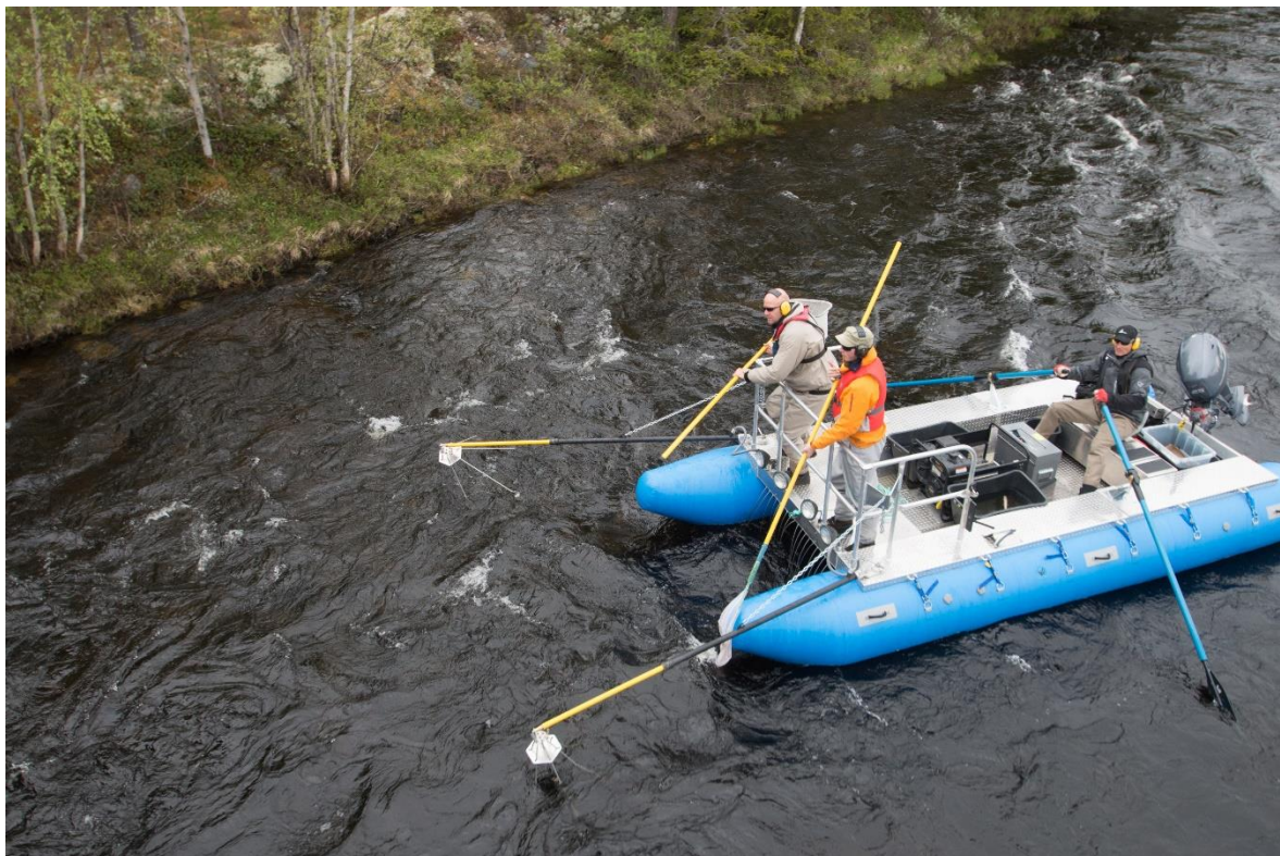
Bilde 2. Det ble benyttet en spesialbygget elektrisk fiskebåt av typen Cataraft ( www.smith-root.com ) i Gaula i 2022 (bildet er fra elektrisk båtfiske i Trysilelva). Foto: Børre K. Dervo, NINA.
