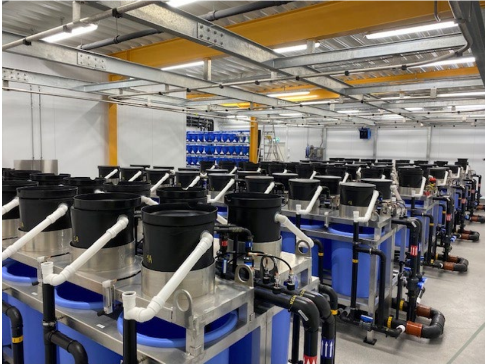
6. Familieklekkeri, klekkesylindere og startforingskar. 96 enheter.
