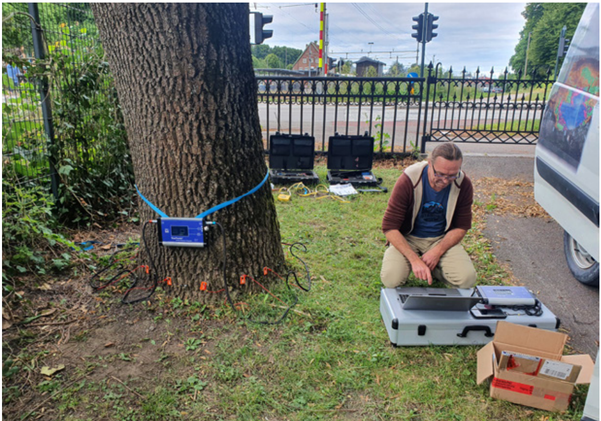
Figur 7. Testing av tomografi på ett tre på Tønsberg gamle kirkegård i 3. august 2021. Foto: Anders Endrestøl.
