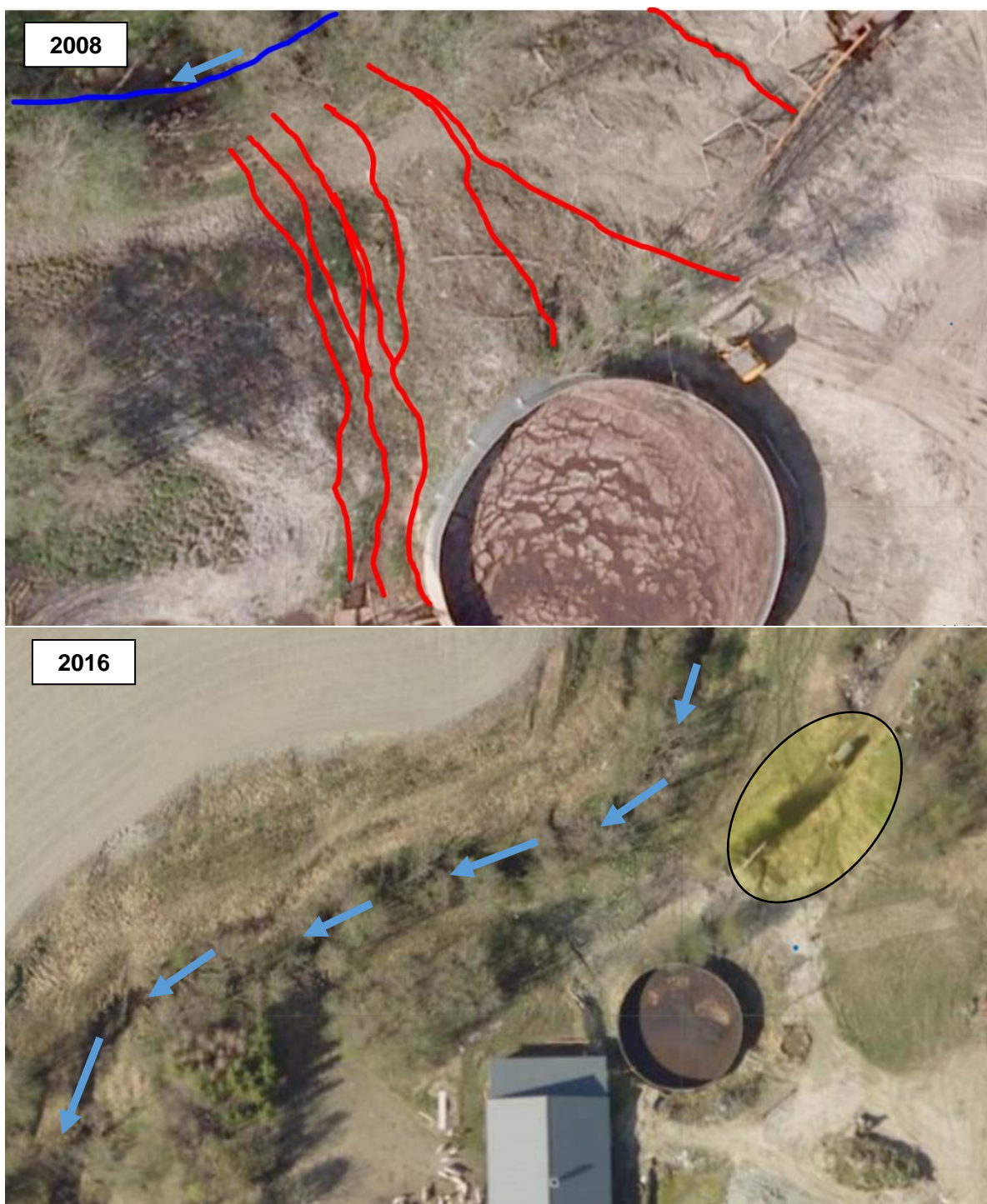
Figur 26. Øverst: Flyfoto fra 2008, like etter gjødseltanken ble oppført, viser potensielle avrenningsgrøfter og spor i terrenget (røde streker) som gjødsel på avveie kan renne ufordrøyd ut i Steindalsbekken (blå linje). Nederst: Flyfoto fra 2016 avdekker en lik status som flyfoto fra 2008, men med noe mer bevokst kantvegetasjon. Lokalisering av dam og påfylling av gjødsel vist med gul farge. Bekkens vannvei-retning vist med blå piler. Flyfoto: https://kart.finn.no/ .
