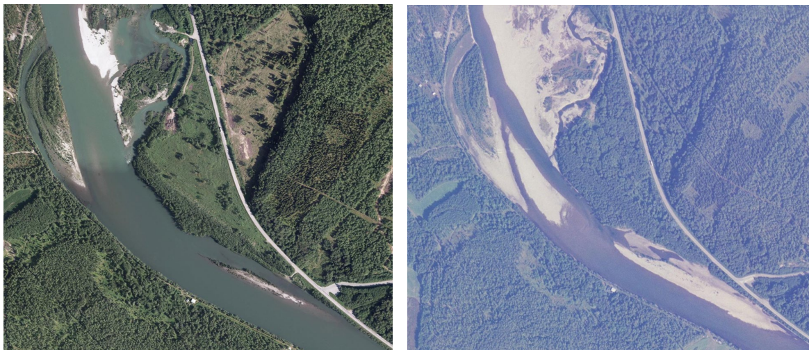
Figur 8. Utsnitt fra flybilder (norge-i-bilder) ved Galsomelen (nedafor søppelfyllingen og vis-a-vis Krakenes) i Reisaelva ved to ulike vannføringer. Bildet til venstre ble tatt 8.7.2014 ved vannføring på 112 m 3 /s (3.0 m), mens bildet til høyre ble tatt 16.8.2006 ved en vannføring på 33 m 3 /s (2.1 m)
