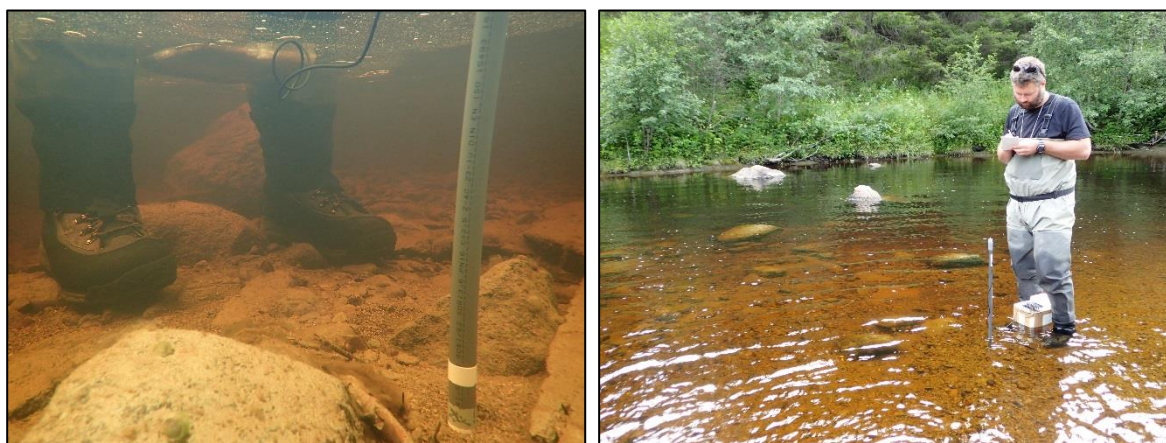
Figur 5. Måling av redokspotensial i substratet. Foto: Bjørn Mejdell Larsen.
