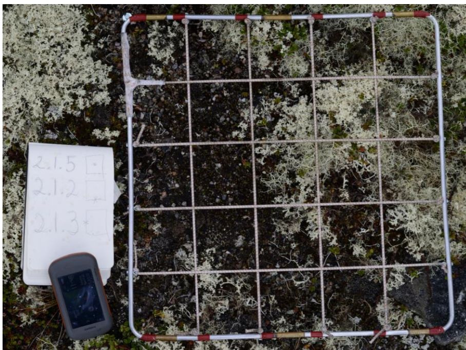
Figur 5.1.8. Måleramme plassert over prøveflate 2.1.3 (dvs. transekt 2, lokalitet 1, prøveflate 3). Her er dekningsgraden av lav anslått til 38 %, dekningsgraden av mineraljord til 56 %, og lavhøyden 30 mm.
