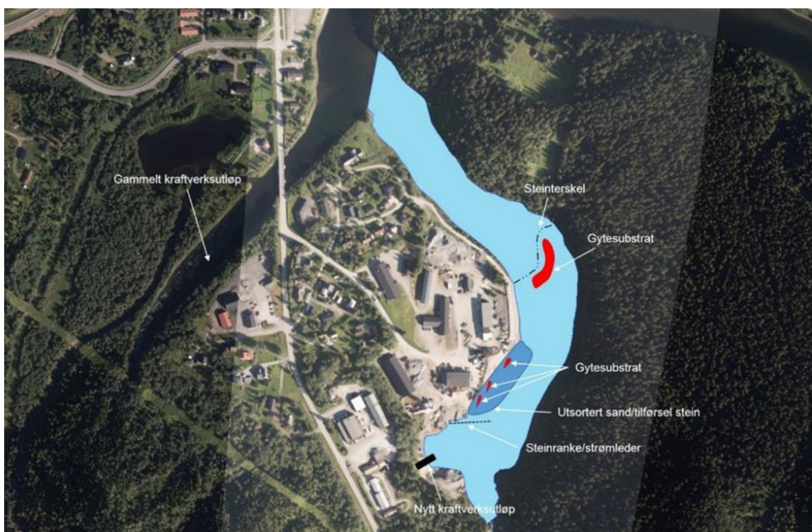
Figur 3. Prinsippkisse for arbeidet knyttet til tiltaksområdet mellom nytt og gammelt kraftverksutløp i Røssåga. Spredt utlegg av steinblokk nedstrøms steinterskel er ikke tegnet inn. Skissen er hentet fra Kanstad-Hanssen et al. (2015).
