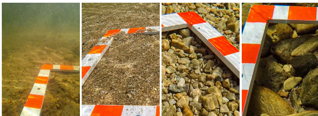
Bilde 17. Metallramme med 5 cm mål for 'kornfordelingsvurdering' (metode 5). Fra venstre mot høyre silt, sand, grus og stein.
