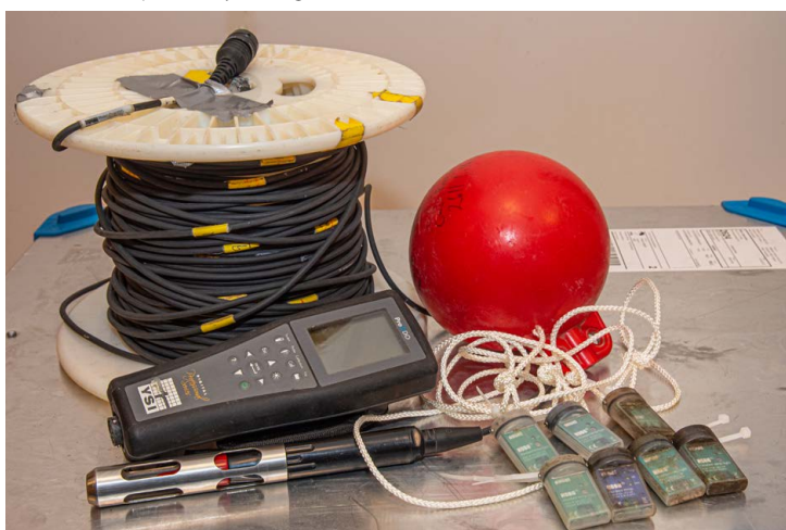
Bilde 28. Multisonde til venstre og temperturloggerne til høyre.
