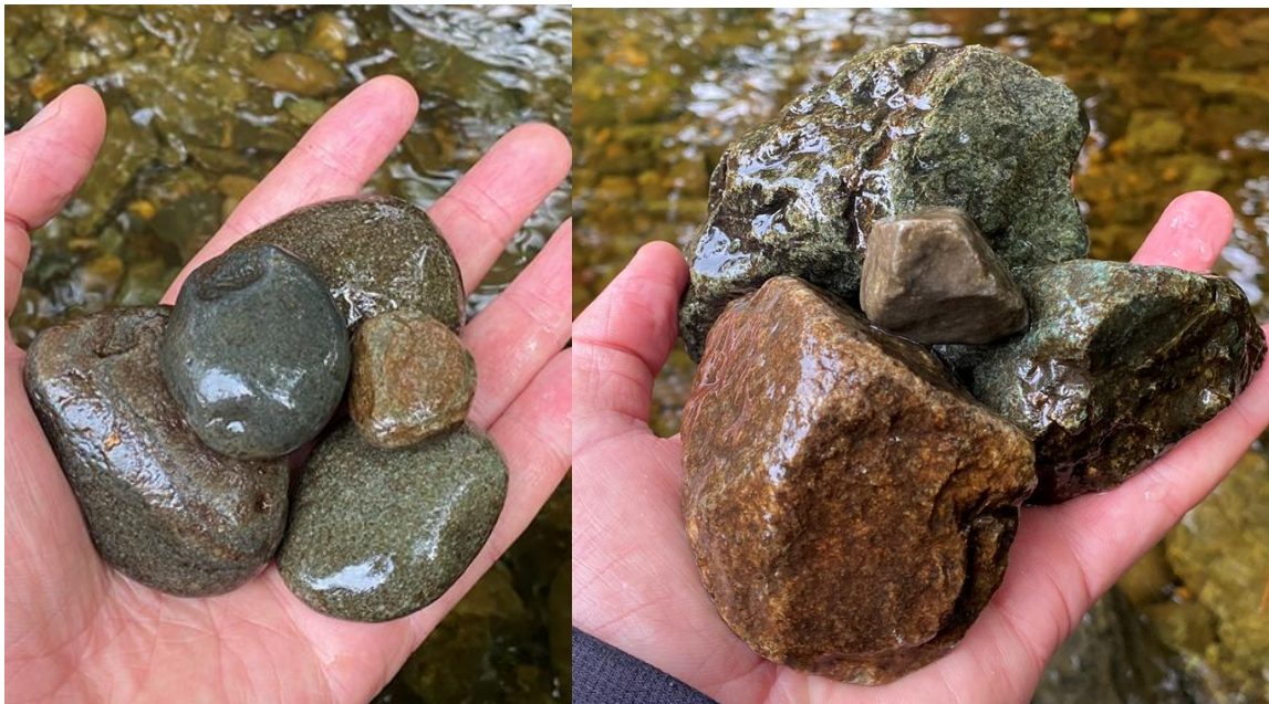
Figur 36. Naturlig elvestein i øvre del av Loddbekken (t.v.) sammenlignet med unaturlig tilført skuttstein (t.h.). Mesteparten av den naturlige elvesteinen og grusen ble fjernet i bekkeløpet i forbindelse med erosjonssikring av bekken i 2013, der bunnen ble erstattet med skuttstein. Slike endringer i substratstørrelser og form påvirker spesielt gytemulighetene til sjørret negativt, og gitt stort nok omfang, så kan vassdrag tape all egnethet for gyting etter slike inngrep. Foto: NINA.
