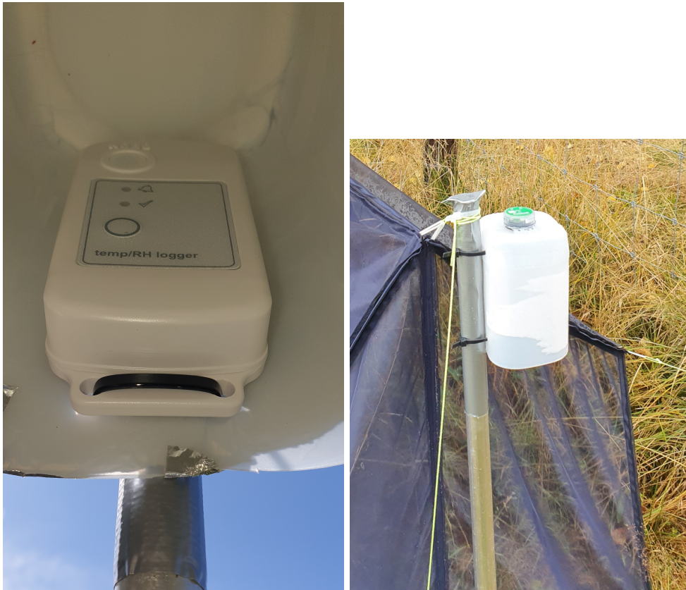
Figur 17: Temperatur og luftfuktighetsmåler av typen Hobo MX2301A (venstre) og temperatur og lysmåler av typen Hobo MX2202 (høyre). MX2301A er plassert i skygge og begge tømmes med blåtann til en skyløsning.
