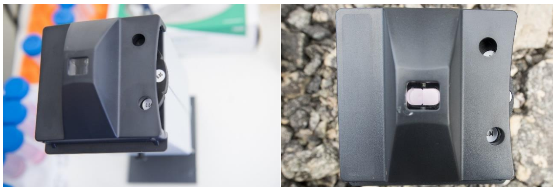
Figur 7. Komparator (venstre) og demonstrasjon av fargenyansen som tilsvarer 40 \mu\text{g} klor/L (høyre bilde). Foto: Anders Gjørwad Hagen/NIVA.
