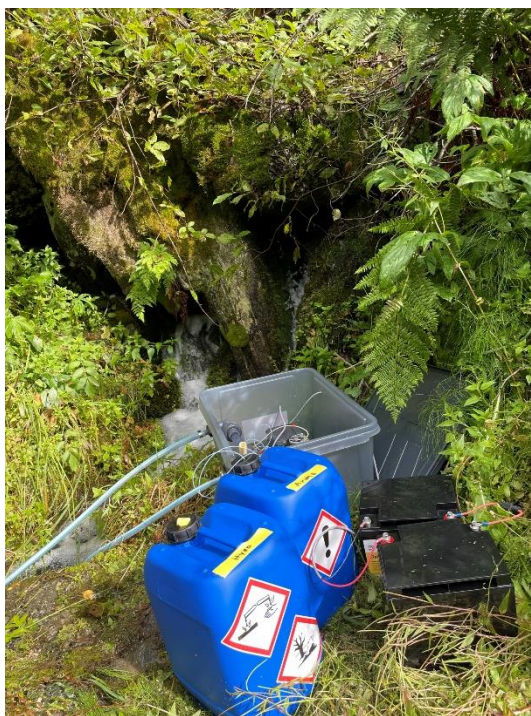
Figur 4. Doseringssystem for sidebækker med kjemikalier (blå kanner), strømtilførsel via batteri, samt pumpekasse.
