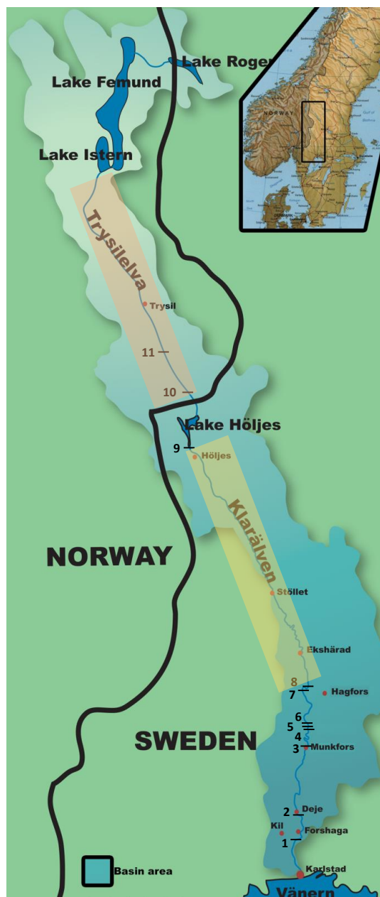
Figur 1. Kart over Klarälven/Trysilelva/Femundselva (modifisert etter: sv.wikipedia.org). Tallene 1-11 indikerer plassering av kraftverk. Gul skravering: gyte- og oppvekstområder for laks som i dagens situasjon fanges ved kraftverk 1 (Fors-haga) og transporteres forbi kraftverkene 2-8. Rød skravering: potensielle gyte- og oppvekst-områder på norsk side, i dagens situasjon forut-satt transport forbi Kraftverk 9 (Höljes). Fisken som transporteres hit kan ha sin opprinnelse fra eksisterende fangsinnretning ved Forshaga eller ved en eventuell ny fangsinnretning i øvre deler av det gulskraverte området.
