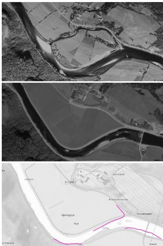
Figur 6.2. Flyfoto av området nedstrøms Bjørsetdammen 1937 (øverst) og 1985 (midt), på bildet fra 1985 er det tydelig av sideløpet rundt Kjerringøya er stengt av og fylt igjen samt at nordre bredde av Orkla er forbygd i hele utstrekningen i bildet. Den fulle utstrekningen av forbygninger er ikke registrert i NVEs database (nedre bilde).
