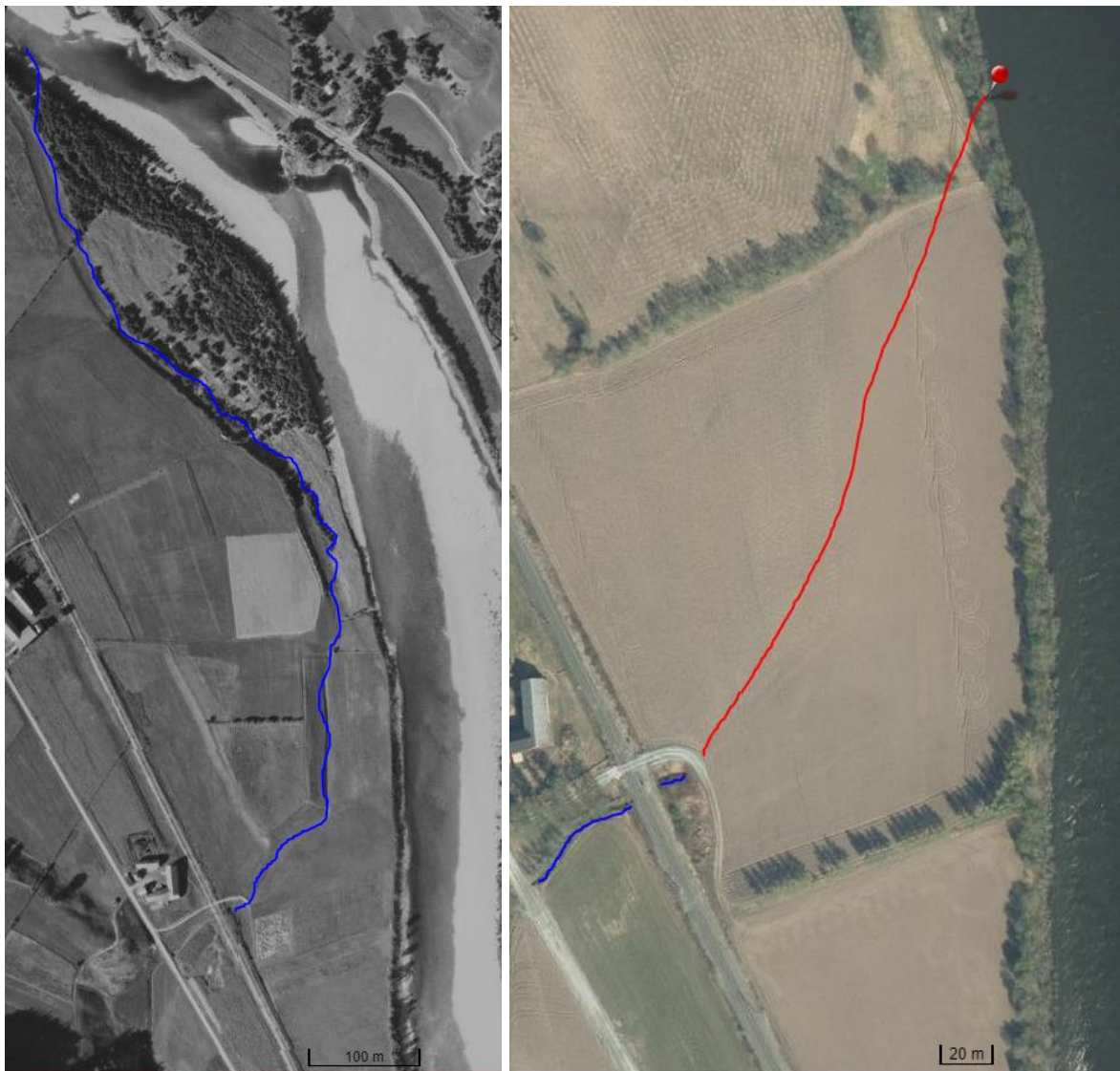
Figur 72. Flyfoto fra 1947 av antatt opprinnelig vannvei (blå linje) i Krossbekken mellom jernbane og tilløp Gaula (venstre bilde), og flyfoto fra 2019 som viser dagens lukkede strekning (rød linje), med endret tilløpspunkt til Gaula (høyre bilde). Kilde: www.kart.finn.no .
