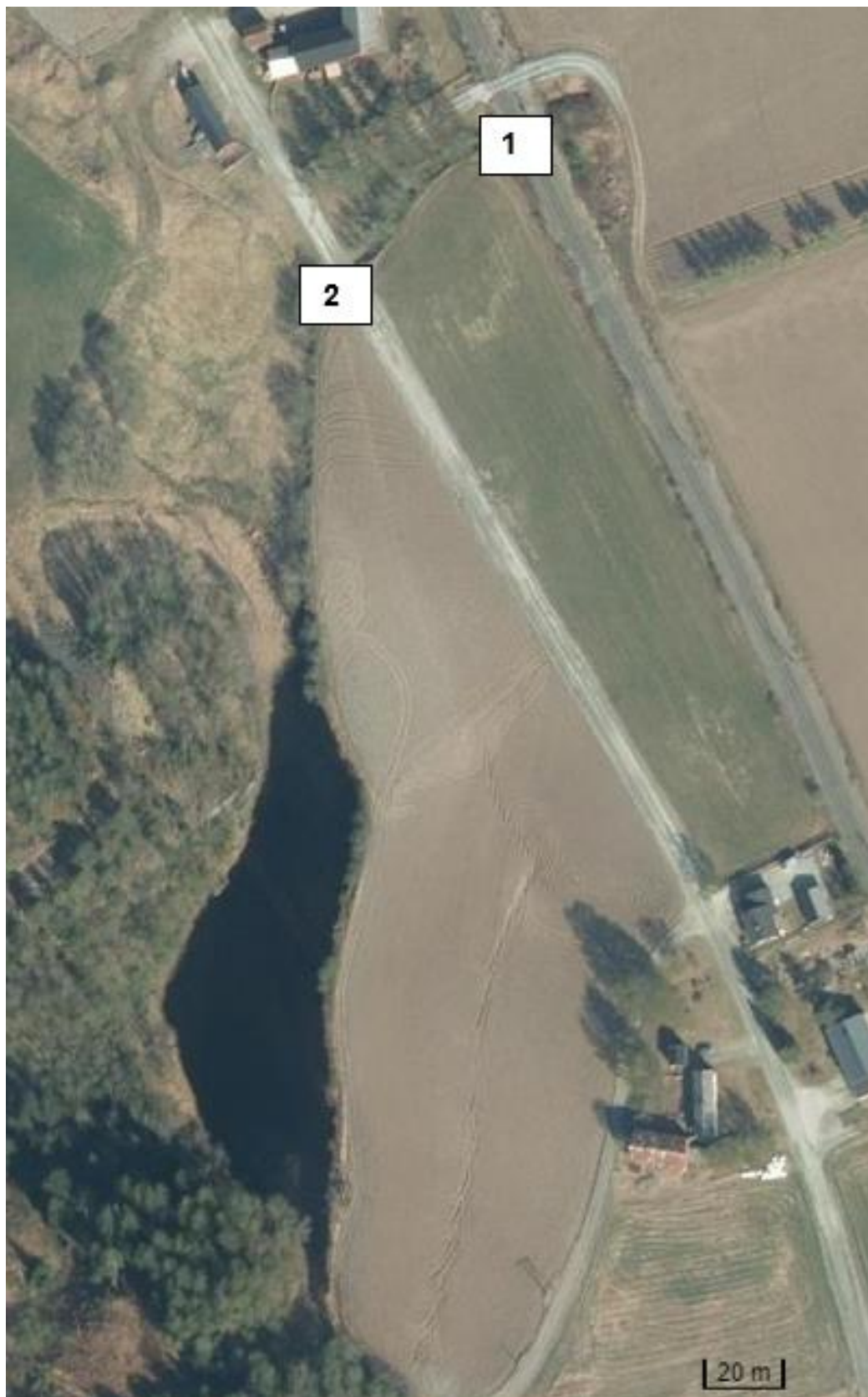
Figur 73. Krysninger av jernbane (1) og Krogstadveien (2) må kvalitetsikres for fiskevandring i forbindelse med gjenåpning og restaurering av Krossbekken nedstrøms jernbane og vei. Flyfoto: www.kart.finn.no .
