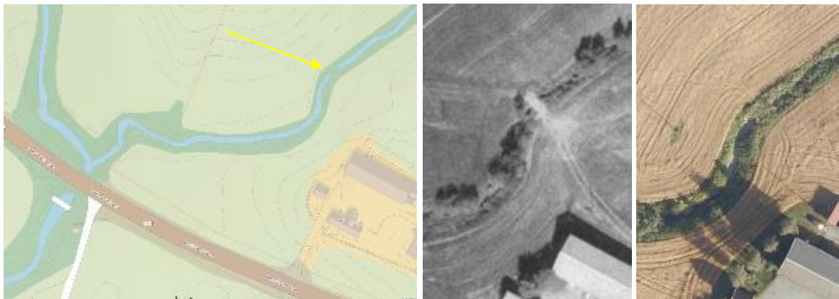
Figur 16. Kulvert under avlingsvei i Ustbekken er vandringstoppende. Bekken er derfor fisketom oppstrøms kulverten. Kilde: www.kart.finn.no .
