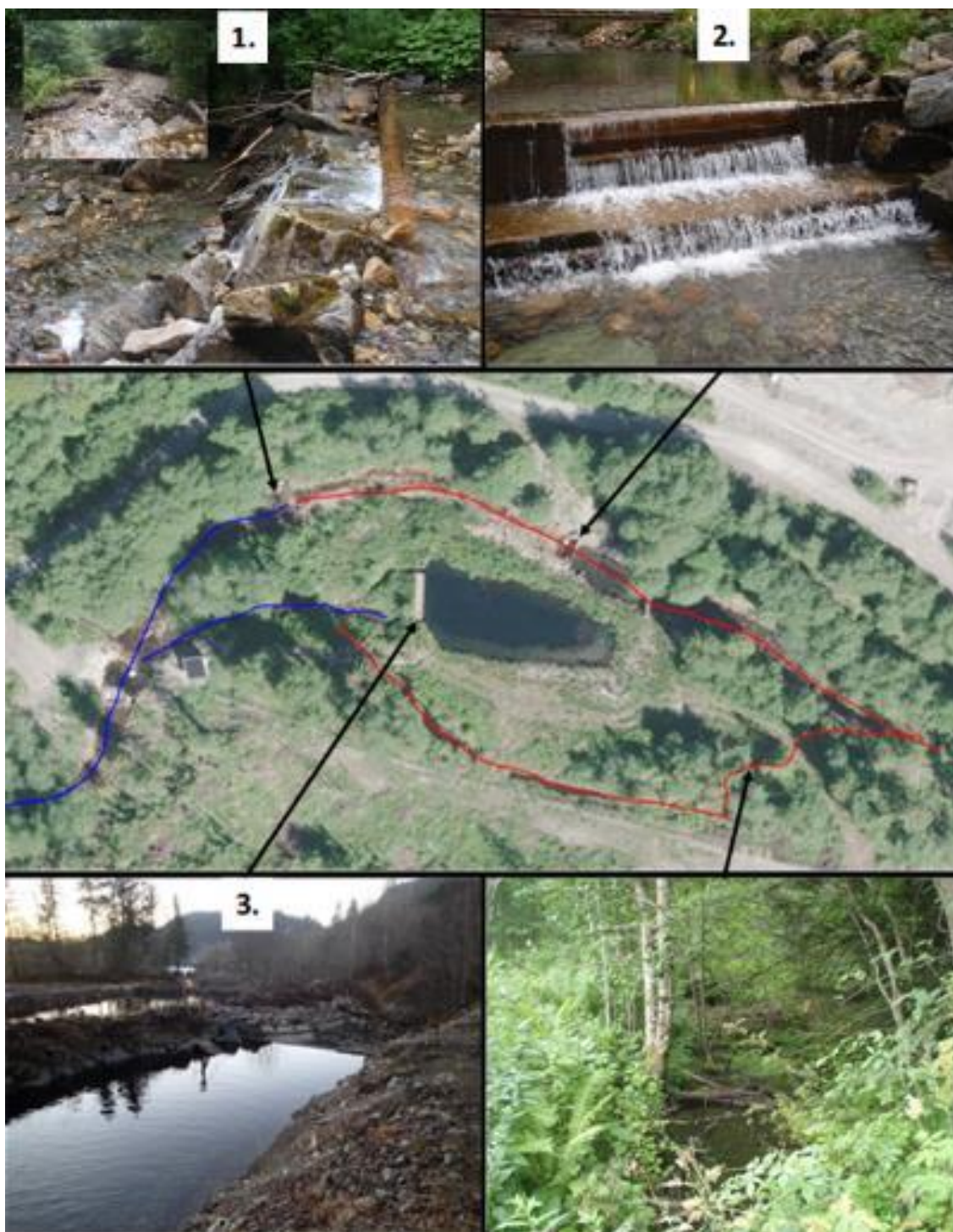
Figur 37. Lokalisering og foto av tre stengsler/demninger i øvre del av Kaldvella. Inngrepene stopper oppgang av anadrom fisk (blå linje: anadrom strekning, rød linje: tapt areal) og fører til om lag 50 % tapt produksjonspotensial for laks og sjørørret i vassdraget. Bildet er hentet med tillatelse fra Eloranta mfl. (2019).
