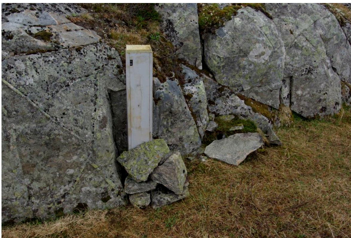
Ferdselstellere måler bruksintensitet på et gitt sted. Her EcoCounter med infrarød sensor. Foto: Vegard Gundersen
