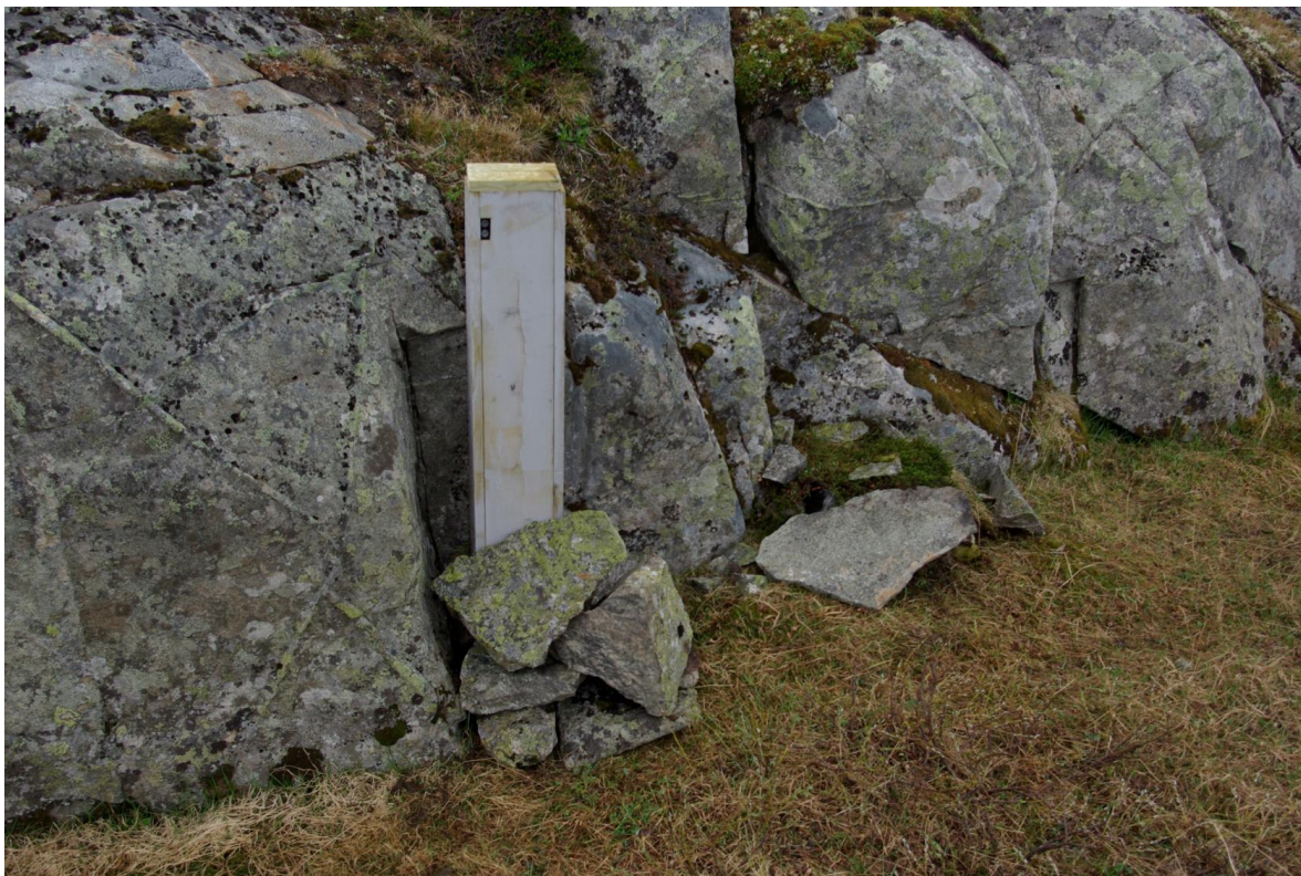
Automatisk teller montert langs Rallarvegen før Finse. I alt 11 tellere ble brukt sommerstid og 8 tellere vinterstid i Nordfjella. Toveis infrarød sensor som registrerer varme fra forbigående på veg inn eller ut. GSM modem sender data direkte til sentral database. Foto: Vegard Gundersen.
