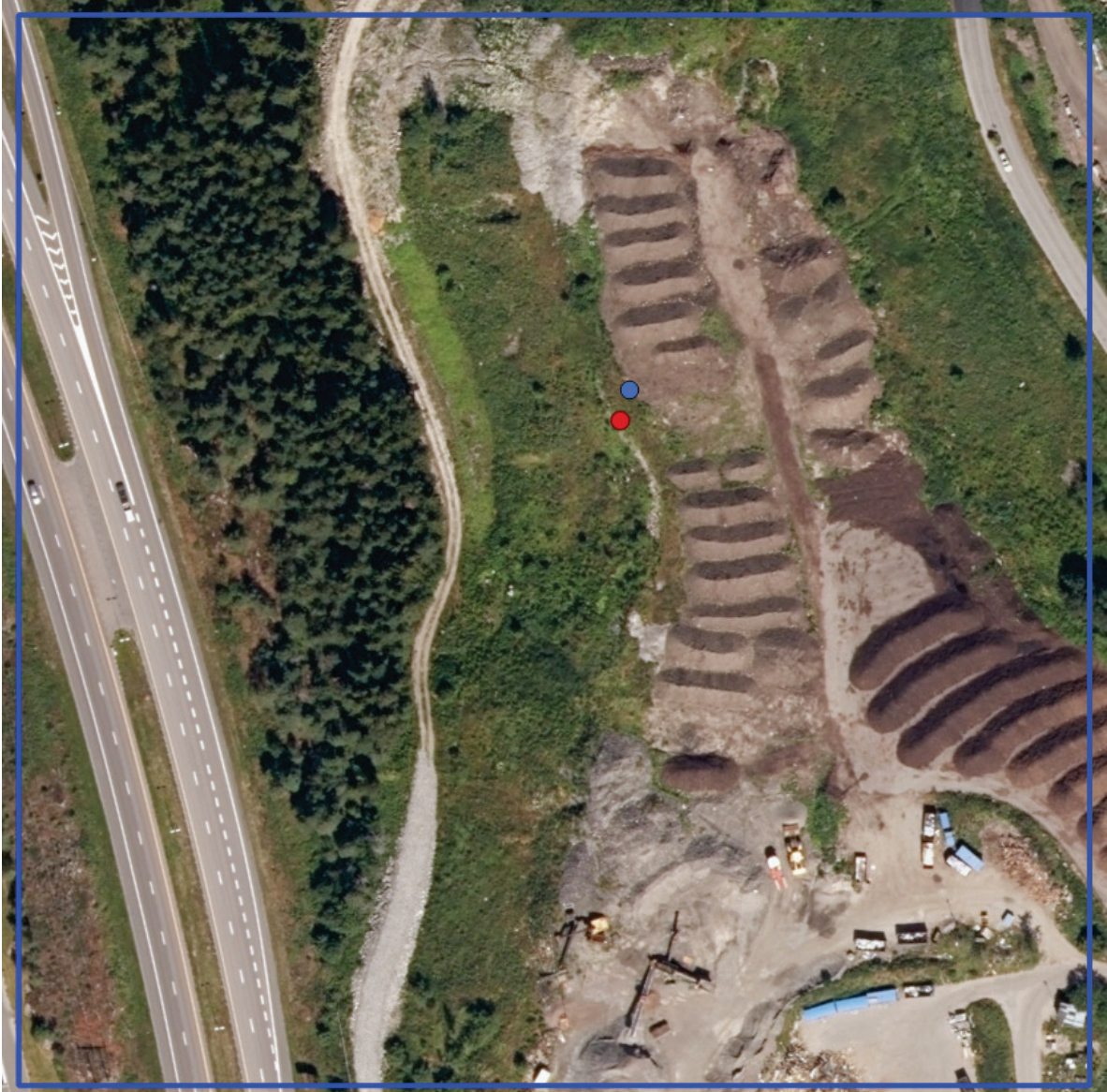
Figur 4.3. Rute 11, Solgård avfallsmottak, der malaisefellen er markert med høypresisjons-GPS (rød prikk) og håndholdt GPS (blå prikk). Avviket mellom disse to posisjonene var på 7.3 meter.
