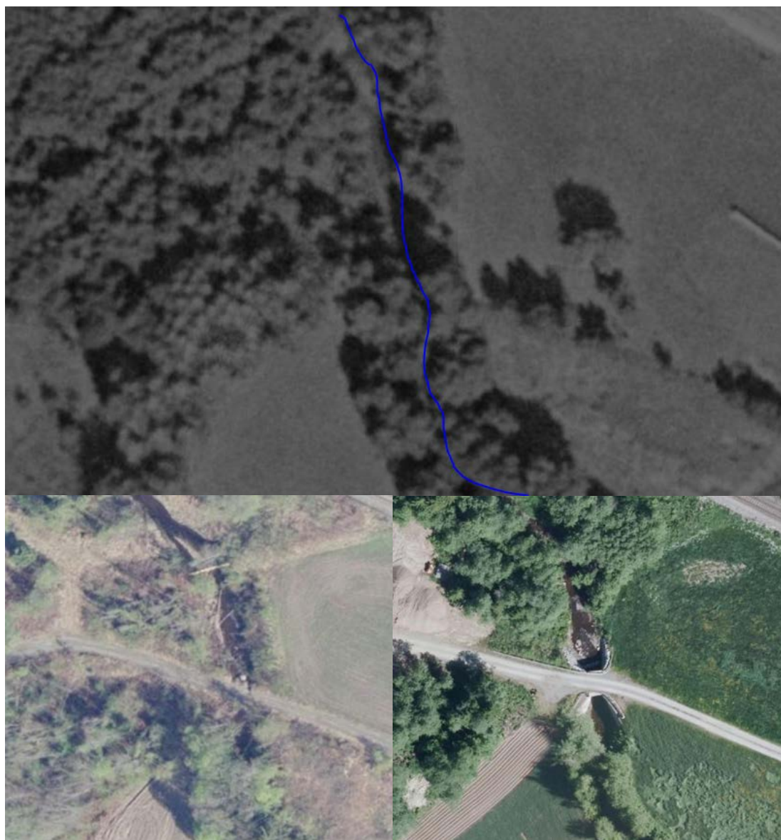
Figur 78. Folstadbekken i 1956 (øverst). Etter 2002 (t.v.) dukker en grusvei opp i nedre del av Folstadbekken, med tydelig innsnevret kulvert. Bekkekrysningen endres radikalt etter 2010 (t.h.). Interessespekket må avklares for fiskevandring.
