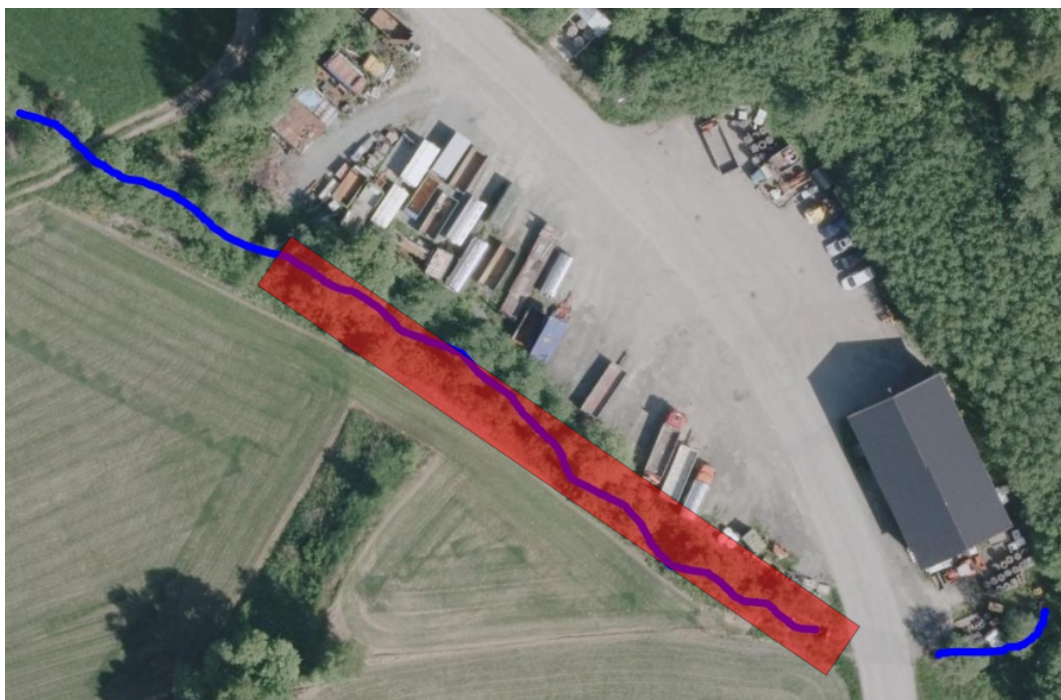
Figur 52. Bekkeparti med nylagt kulvert og lukking av bekken (rødt felt, anslag) nedstrøms Fossvegen. Inngrepet vises ikke på flyfoto fra primo 2019, så inngrepet er gjennomført denne sommeren/høsten. Flyfoto: https://kart.finn.no/ .
