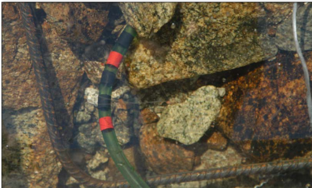
Figur 3. Utstyr for å måle antall skjul innenfor en rute i elvebunnen (se forsidebilde) for laksunger av ulik kroppsstørrelse, som klassifiseres i tre ulike størrelsesgrupper ved bruk av silikonslanger av ulik tykkelse. Armeringsjernet danner en rute på 0,5 m x 0,5 m.
