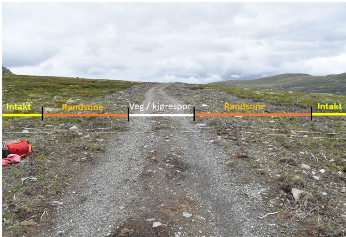
Figur 2.4. Transektene legges ut på tvers av anleggsvegen/kjøresporet, gjennom overgangssonene på begge sider og ut i intakt vegetasjon.
