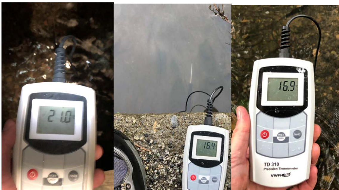
Figur 15. Stor økning i vanntemperatur ved måling i kum (t.v., st. E6c) inne i fabrikken hos Norsk Kylling AS, nedstrøms fabrikken (midten, st. E5) og strekninger videre nedover bekken (t.h., st. E3) den 21. september 2018 (foto: Morten Andre Bergan).
