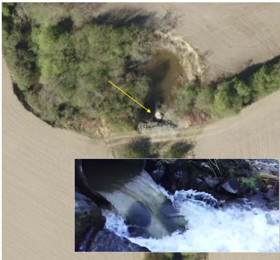
Figur 12. Stort foto: Flyfoto fra 2016. Gul pil: traktorveikrysning over Eggbekken stopper regelmessig, årlig oppgang av sjørørret til viktige gyteområder lenger opp i bekken. Flyfoto: https://kart.finn.no/ . Lite, innfelt foto: Screenshot fra video av inngrepet, tatt den 18. november 2017. Video: Lars Eivind Nielsen/privat.
