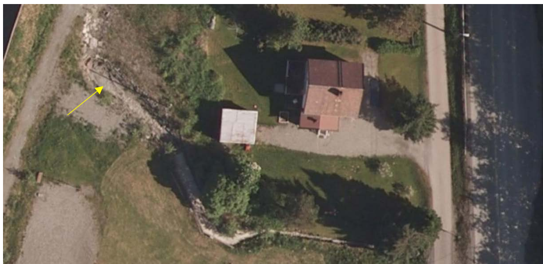
Figur 61. Flyfoto avslører at Stygårdsbekken er konstant svært partikkelforurensset (gul pil), trolig knyttet til avrenning fra grus/sandtak nært bekkeløpet. Flyfoto: https://kart.finn.no/
