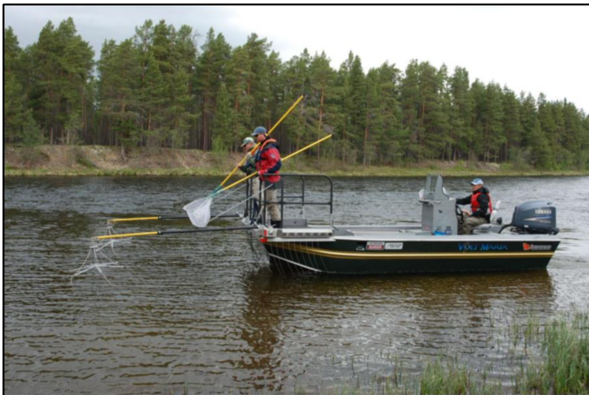
Bilde 3. Under det elektriske båtfisket ble det benyttet en 18 fots aluminiumsbåt med en 200 hestekrefters utenbordsmotor med vannjet. Illustrasjonsbildet er fra en tilsvarende undersøkelse i Rena. Foto: Jon Museth, NINA.
