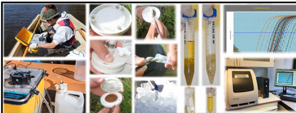
Figur 4.2. Vannprøver på ~5 liter ble filtrert på stedet ved hjelp av en portabel peristaltisk pumpe. Filterene ble overført til falcon-rør og oppbevart på is før lagring på frys. DNA ble isolert med en CTAB ekstraksjonsmetode og tilstedeværelsen av eDNA fra edelkreps, signalkreps og krepsepest ble undersøkt med qPCR.
