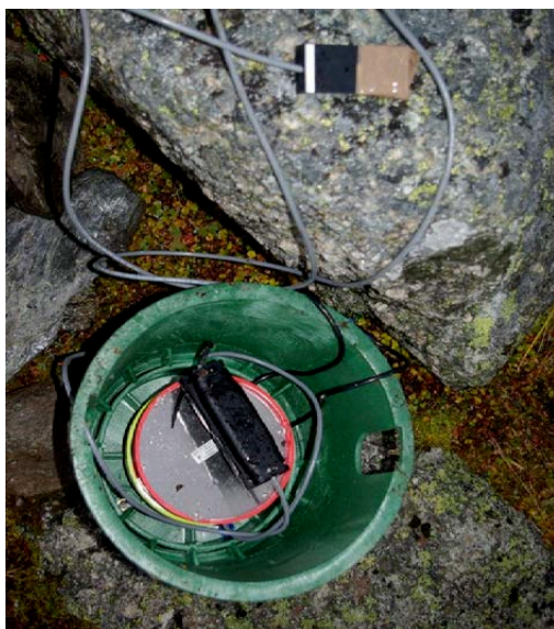
Figur 3. Ecocounter combo teller med telleverk, GSM modem, batteri og sensor. Foto: Vegard Gundersen
