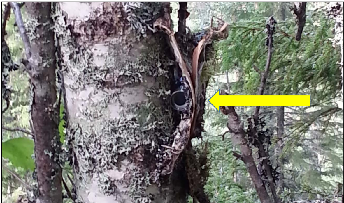
Figur 4 Ferdselsteller montert på bjørkestamme, kamuflert med never, sett rett forfra. Sirkelen er sensoren som peker vinkelrett over stien. Foto: Line C. Wold
