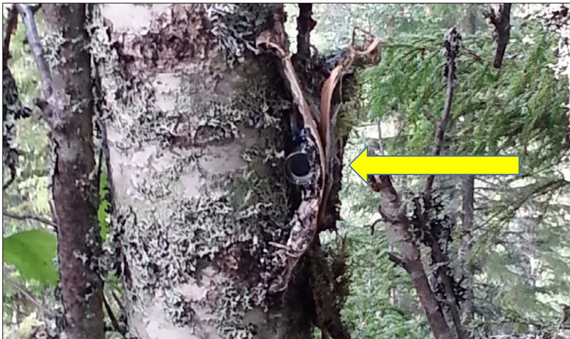
Figur 4. Ferdselsteller montert på bjørkestamme, kamouflert med never, sett rett forfra. Sirkelen er sensoren som peker vinkelrett over stien. Foto: Line C. Wold
