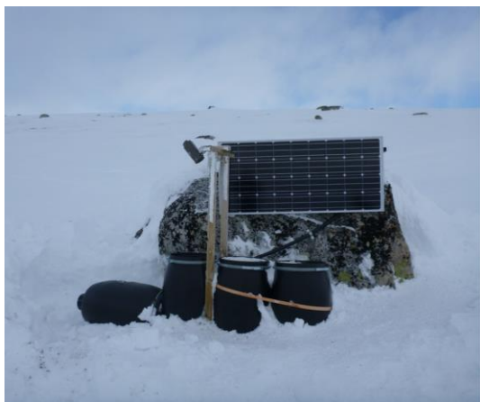
Figur 3. Illustrasjon på design av fôrautomat (Roger Meås, NINA) og bilde av fôrautomat med montert biomarkleser og solcellepanel. Foto: Knut Nylend, SNO.
