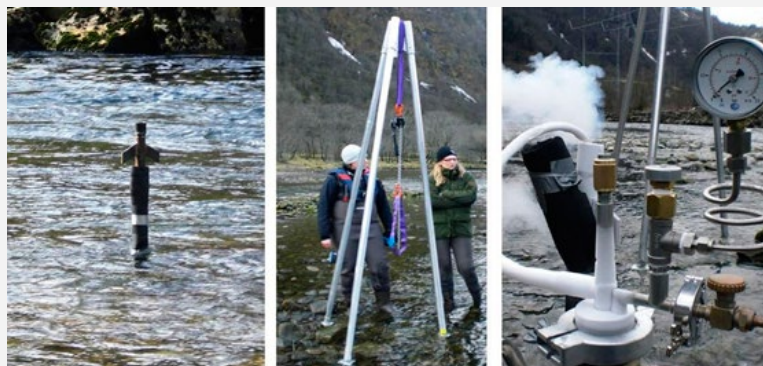
Prøvetaking av frysekjerner hvor bildet til venstre viser stålrøret som er drevet ned i elvebunnen med slegge, stativet for å trekke prøven opp i det midtre bildet og gassbeholder med nitrogen til å fylle i stålrøret helt til høyre. Foto: Martin Honsberg"
