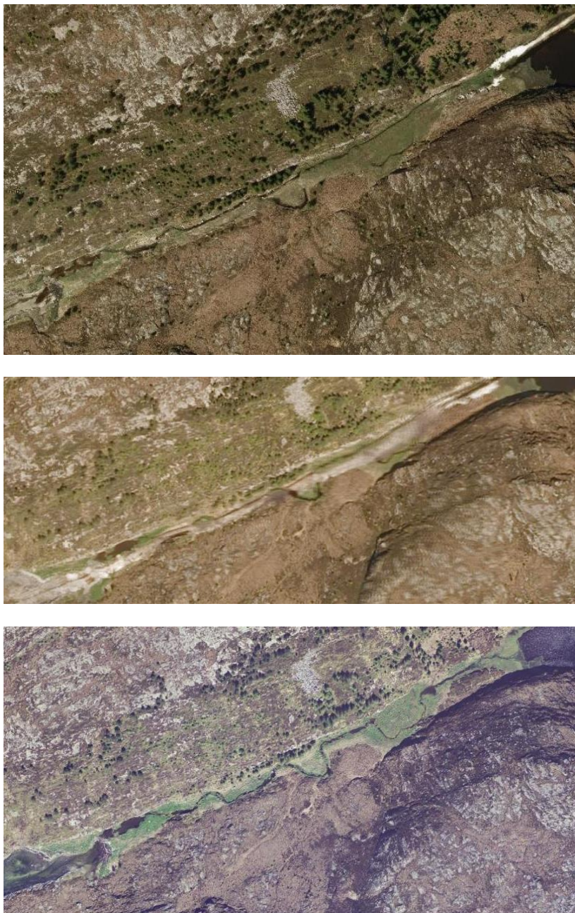
Figur 104. Utretting og degradering av utløpsbekken fra Littljønna er gjort i nyere tid. Flyfoto fra 2006 (nederst) viser naturlig meanderende bekkeløp med høy kvalitet og velegnet habitat for sjørret, mens bilde fra 2008 (midten) viser pågående inngrep i bekkeløpet. Flyfoto fra 2012 (øverst) viser ferdig inngrep og utrettet bekkeløp uten naturlig bekkesubstrat, reduserte gytemuligheter og mangel på kulper og skjul. (Flyfoto hentet fra http://kart.finn.no/ )
