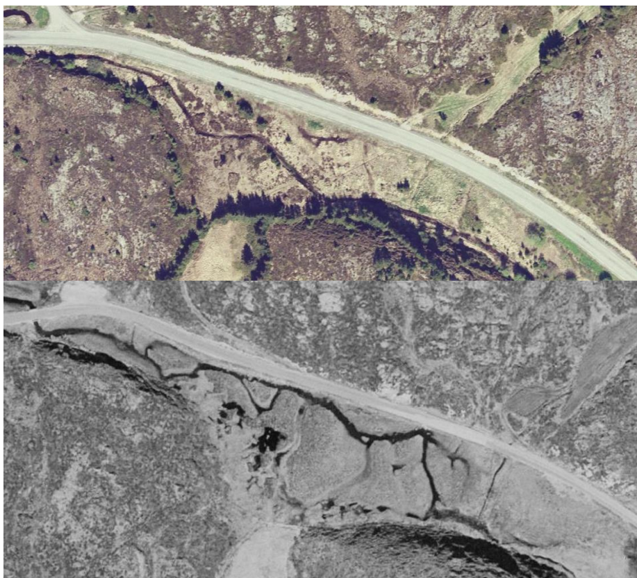
Figur 21. Noe utrettet og utgrunnet elvestrekning i Sandvasselva nedstrøms Fv 716. Flyfoto fra 1968 (nederst) og 2006 (øverst). (Flyfoto fra http://kart.finn.no/ ).
