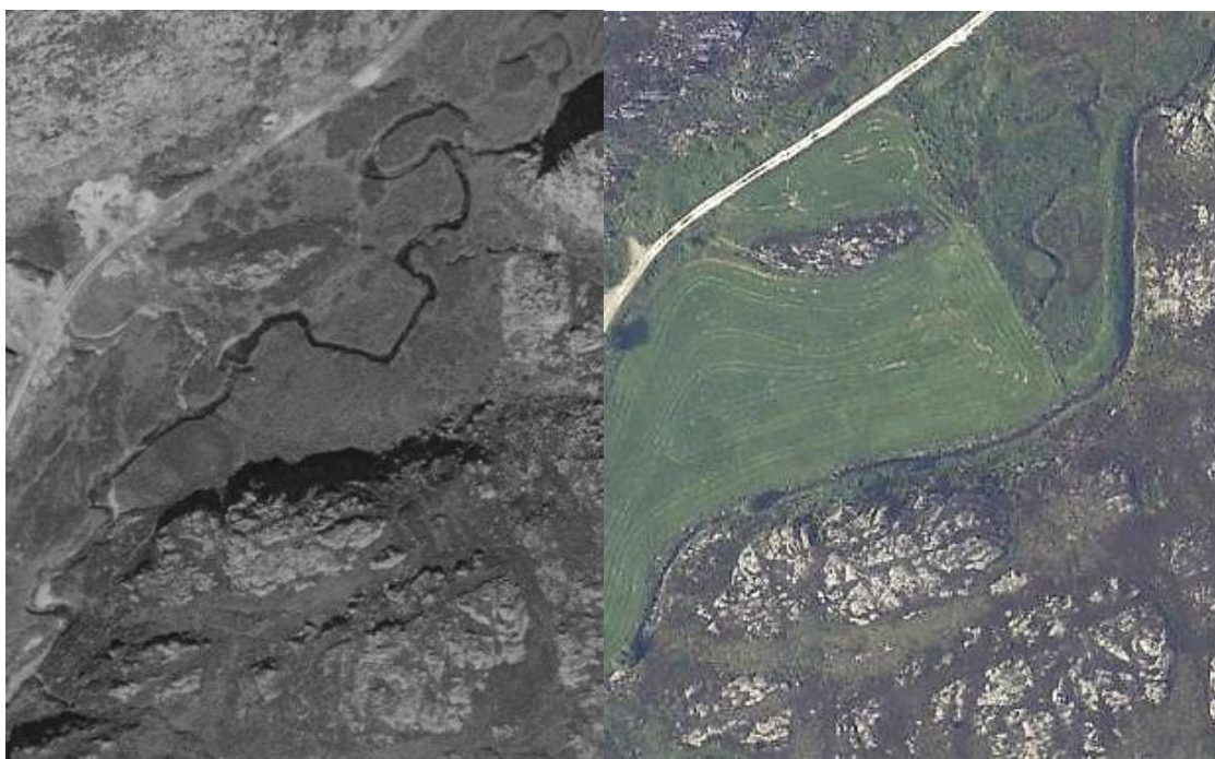
Figur 29. Flyfoto fra 1958 (t.v.) sammenlignet med 2006 (t.h.) og nyere viser at deler av vannforekomsten er utrettet og endret sammenlignet med naturtilstand, noe som har redusert produktivt areal og habitatkvalitet for sjørret. Omfanget ser foreløpig ut til å være relativt beskjedent, og det blir viktig å ivare resten av de intakte vassdragskvaliteten i denne vannforekomsten.
