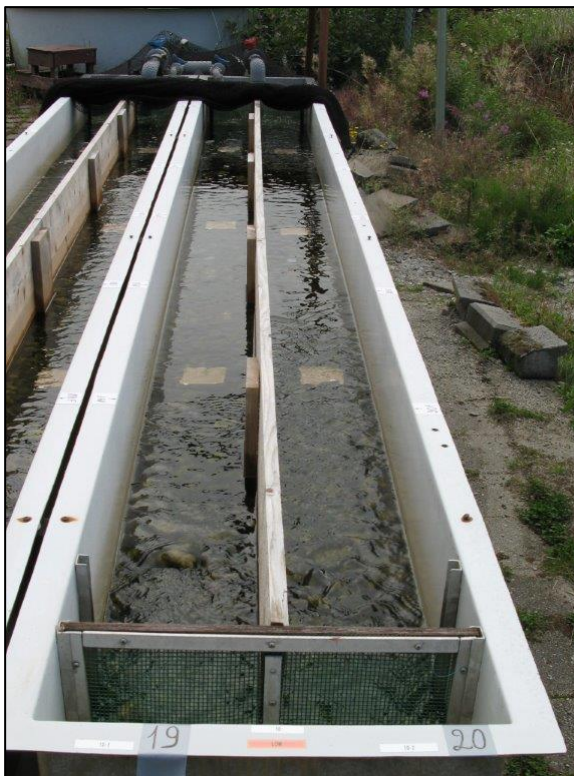
Laksunger behandlet med veksthormon eller kontrollbehandling ble satt ut i kunstige bekker med naturlig elvesubstrat. Flisene som er lagt ut brukes til å måle primærproduksjon ved hjelp av instrumentet Benthotorch. Foto: Line Sundt-Hansen
