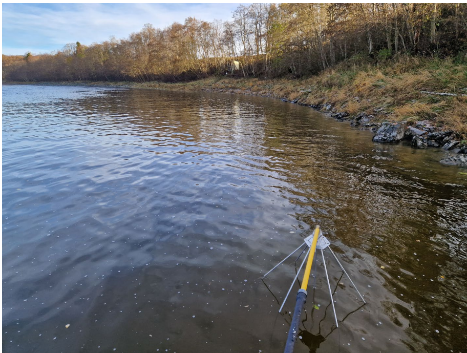
Bilde 2. Katodearmen på elfiskebåten under avfisking av transekt 1 på Nedre Leberg. Miljøtilpasset erosjonssikring av elvebredden (avsnitt 2.2.3) ses i bakgrunnen. Foto: Erik Friele Lie.
