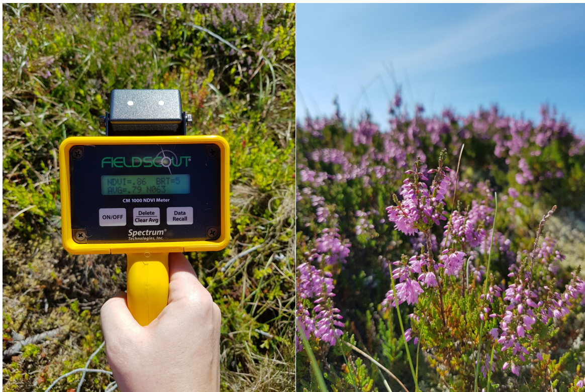
Figur 6. Instrument for optiske målinger av innhold av klorofyll, FieldScout CM 1000 NDVI Meter t.v., og røsslyng i full blomst t.h. © Mari Jokerud
