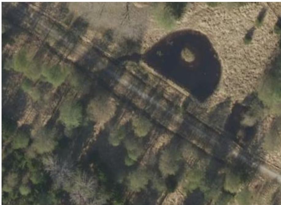
Figur 17. Ødemørk grøft (F9) langs veien på nedsiden i bildet. Utvidelse og oppdemming av denne dreneringsgrøfta må gjøres med forsiktighet slik at skader på veien unngås ved kraftig nedbør. Kilde: Norge i bilder, Kartverket.
