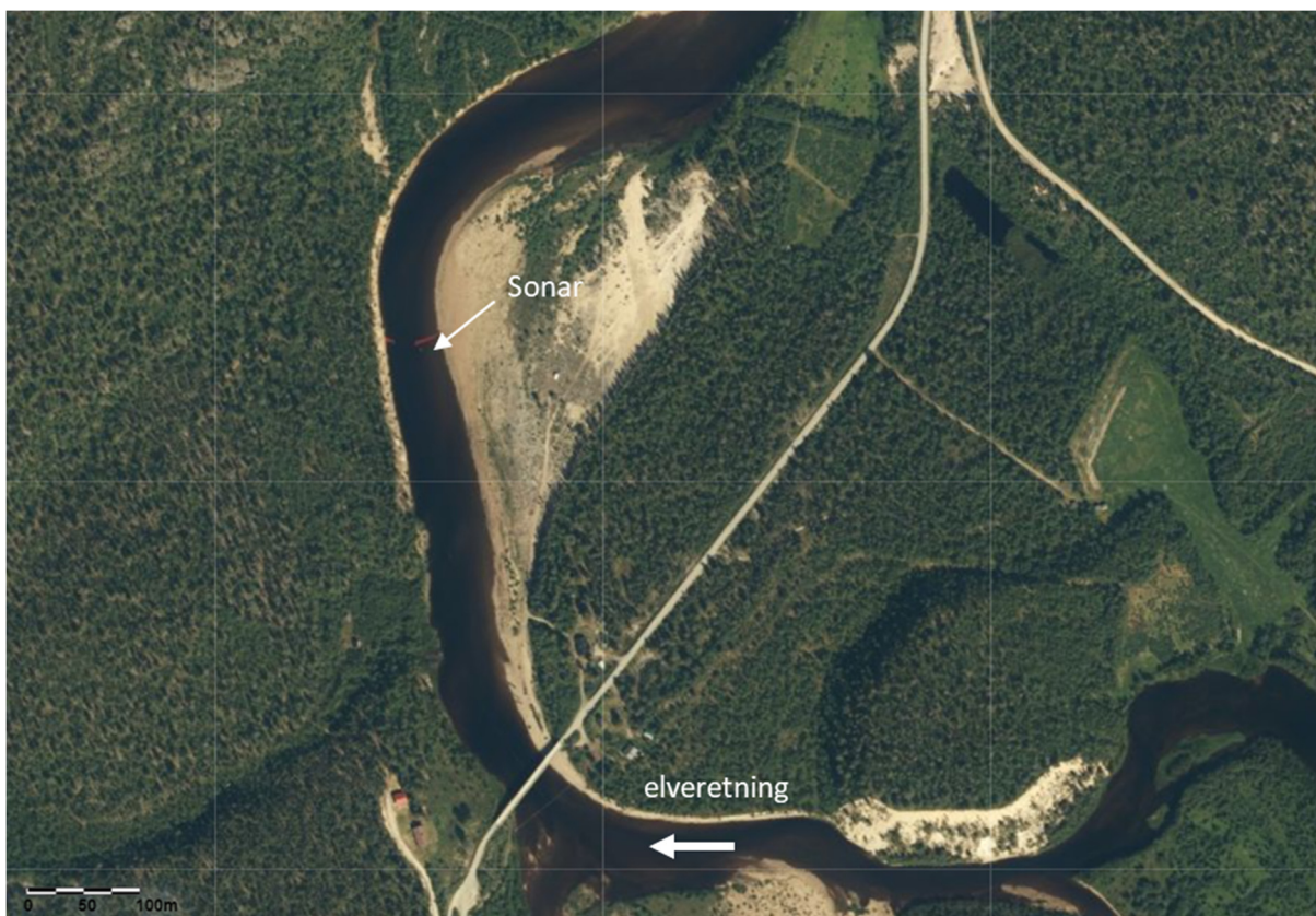
Figur 16. Flyfoto som viser overvåkningslokaliteten i Heastanjårga, øvre Kárásjohka. Plassering av sonar er markert med pil, og like nedstrøms (nord/opp på bildet) sees de røde ledegjerdene. Bildet er tatt 30. juli 2020. Kilde: www.norgeibilder.no .
