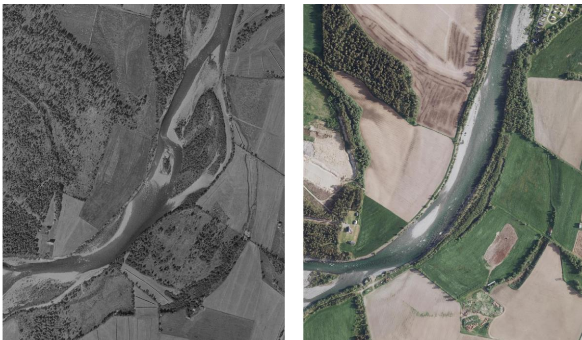
Figur 17. Flyfoto av strekningen ved Sætrumsmoen fra 1958 (venstre) og 2019 (høyre) viser tap av sideløp, kulper og gyteområder som følge av forbygning.
