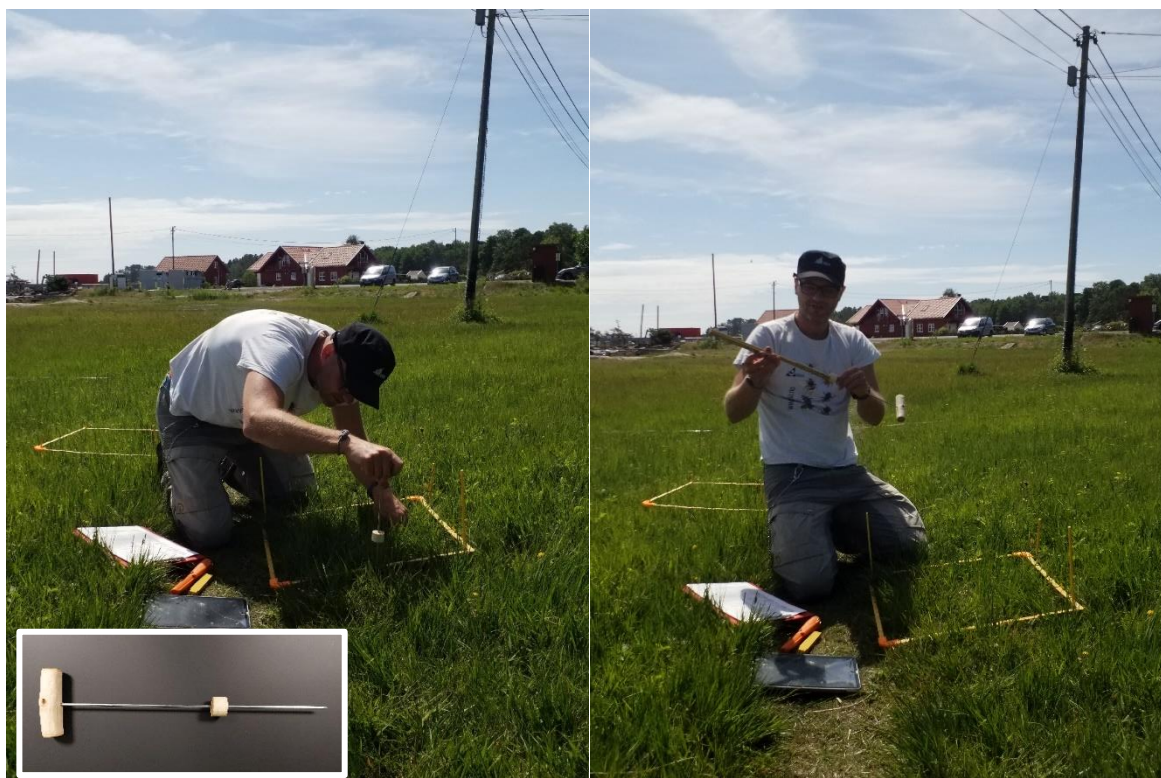
Figur 4.5. Jorddybde ble målt til nærmeste 0,5 cm på to punkter per overvåkingsrute. En tynn pinne ble stukket ned så langt det gikk, og en trekloss ble skjøvet ned til jordoverflaten. Deretter målte vi lengden fra klossen til enden av pinnen. Foto: Marianne Evju/NINA.
