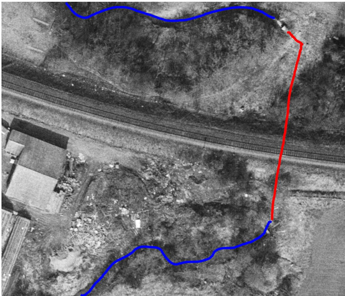
Figur 14. Forlenget lukking av Sjøskogbekken og nedlegging av vandringsstoppende kulvert nedstrøms eksisterende jernbanelinje i perioden 1976-1981 medførte at sjøørreten ble stengt ute fra oppstrøms strekninger i bekken. Flyfoto fra 1981. Flyfoto: https://kart.finn.no
