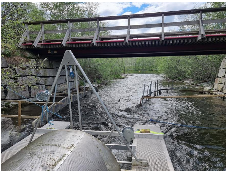
Vedleggsbilde 16. Ledegjerde som samler vannet samt øker strømhastigheten inn i smolthjulet. Foto: Øyvind Solem, NINA.
