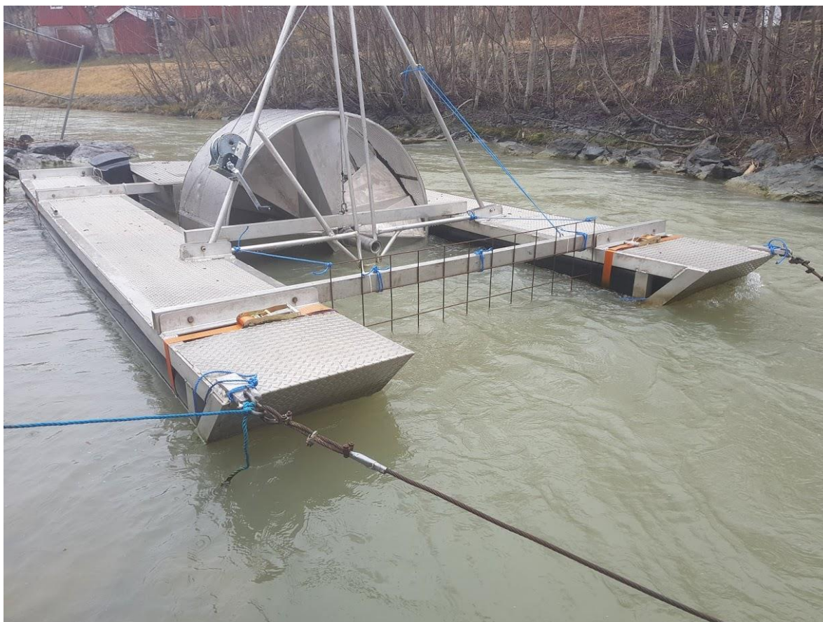
Vedleggsbilde 3. Gitter som ble montert i fremkant på smolthjulet for å hindre fangst av bever. Foto: Øyvind Solem, NINA.
