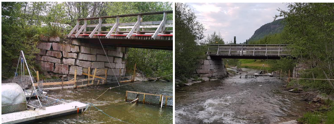
Vedleggsbilde 2. Ledegjerde som ble montert for å samle og øke hastigheten på vannet ned mot smolthjulet. Foto: Øyvind Solem, NINA.
