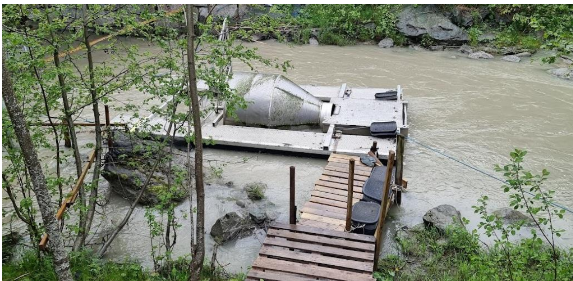
Vedleggsbilde 13. Smolthjul med oppbevaringsstamper for smolt i bakkant av smolthjulet. Stampene på rampen blir brukt til å oppbevare smolt etter merking og før de slippes tilbake i vassdraget etter 4-8 timer. Foto: Øyvind Solem, NINA.
