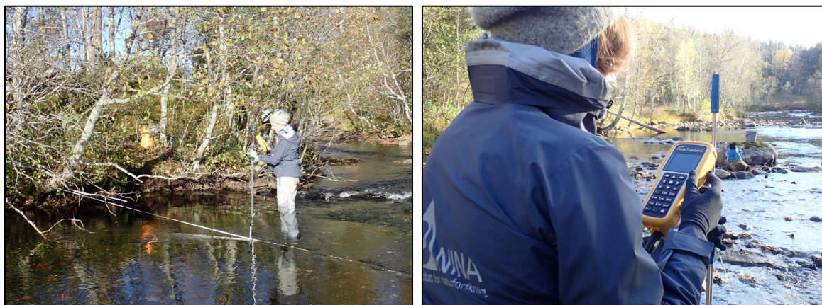
Figur 3. Måling av dybde og vannhastighet langs tverrsnitt i Mølnelva med SonTek Flowtracker 2 (Foto: Bjørn Mejdell Larsen)
