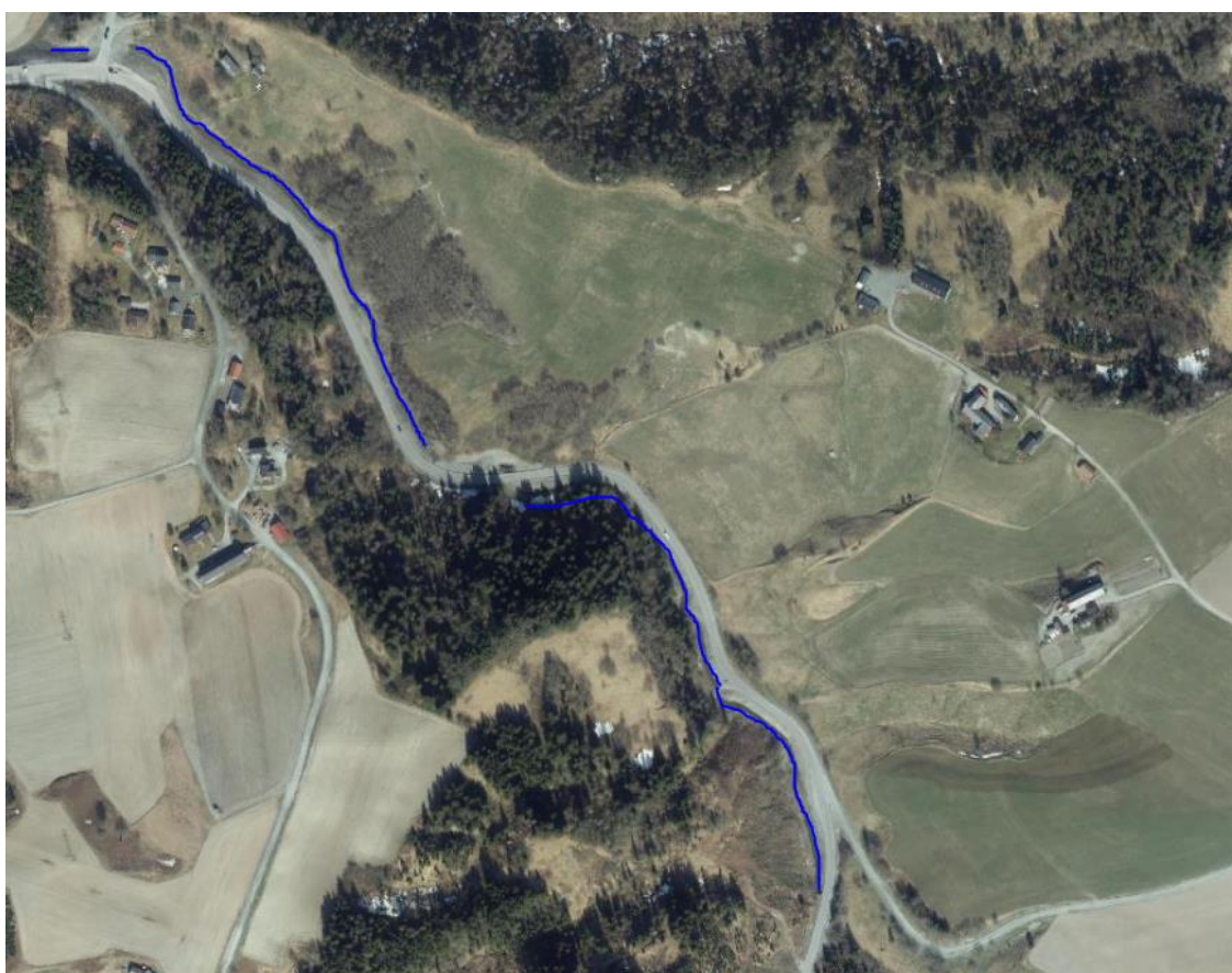
Figur 25. Om lag 1 kilometer bekkestrekning i nedre del av Solemsbekken ble ras- og erosjon-sikret i perioden 2009-2018 (blå linje); inngrep som førte til utretting, avsmalning og fjerning av naturlig vassdragskvaliteter som elvestein, kantvegetasjon og andre økologisk viktige elementer i bekken. Flyfoto fra 2019. Flyfoto: https://kart.finn.no/
